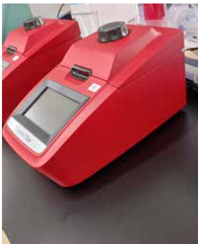
▲ 微量な DNA を増幅する装置。新型コロナウイルスの PCR 検査でも同様の機械が使われている ▼ 微量な DNA 溶液を正確に分取できる
