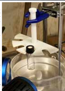
▶ 複数のバイアルを吊すための器具は3Dプリンターで自作。 ◀ 薬剤を少量だけ検出するキャピラリーも手作り。「有機合成屋さんにはガラス細工ができないとね」と吉野さん。
