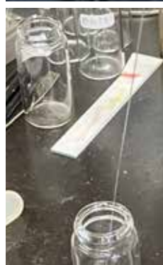
▶ 複数のバイアルを吊すための器具は3Dプリンターで自作。 ◀ 薬剤を少量だけ検出するキャピラリーも手作り。「有機合成屋さんにはガラス細工ができないとね」と吉野さん。
