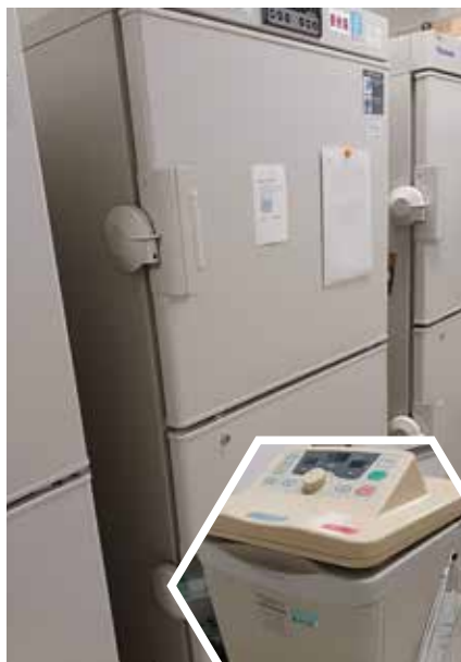
▲ DNA 試料を精製する実験機 ▼ 試料は溶けないように -80 度に保管されている
