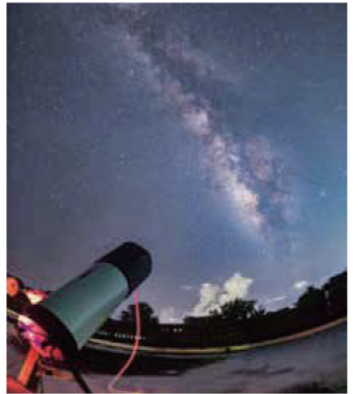
図2 沖縄・宮古島で実施した恒星モニタ観測の様子。独自に開発した小型観測システムを使用し、史上初めて太陽系外縁の小天体の発見に成功した。
