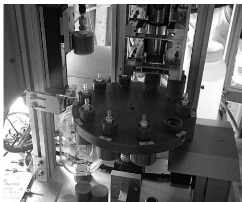
改良版の自動採水機のフィルター設置用円盤
