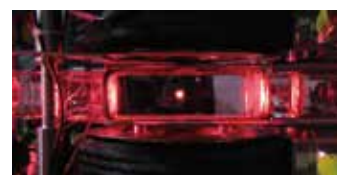
超高真空ガラスセル中で磁気光学トラップされている冷却Li原子気体 Magneto-optical trapping of cold Li atoms in an ultra-high vacuum glass-cell
