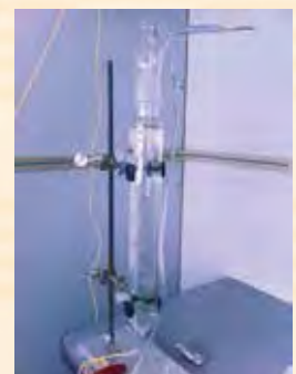
プランクトンの連続培養装置（ケモスタット） A continuous flow-through system to culture plankton (a chemostat)
