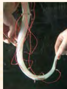
シリコンでできた腕のダイナミクスを計算機として用いる Soft silicone arm as a part of computational device
