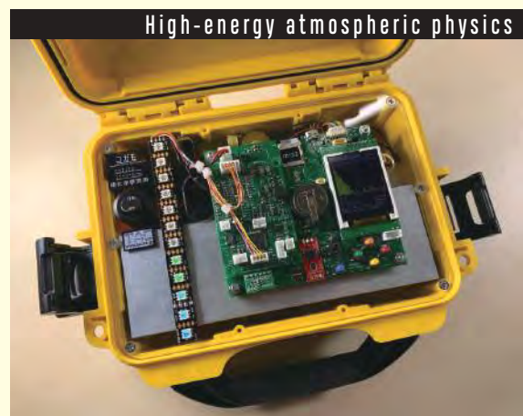
シチズンサイエンス「雷雲プロジェクト」で配布したコガモ検出器
