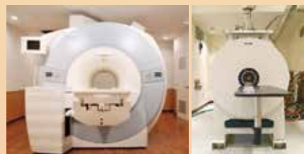
人体用(左)と小動物用(右)のMRI装置 中に入る穴の直径は人体用が60cm、小動物用が21cmと大きさも違います。
